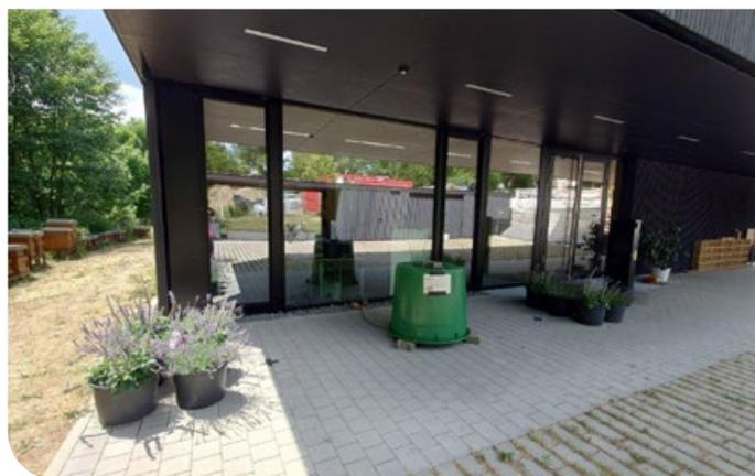
**Abbildung 7: Aufbau des EMF-Versuchs vor dem Haupteingang der Landesanstalt für Bienenkunde.** Unter der grünen Tonne in der Mitte befand sich die Strahlungsquelle, während die untersuchten Pflanzen in 2 Blöcken mit je 6 Pflanzkübeln in einem definierten Abstand zu Strahlungsquelle aufgestellt wurden.
